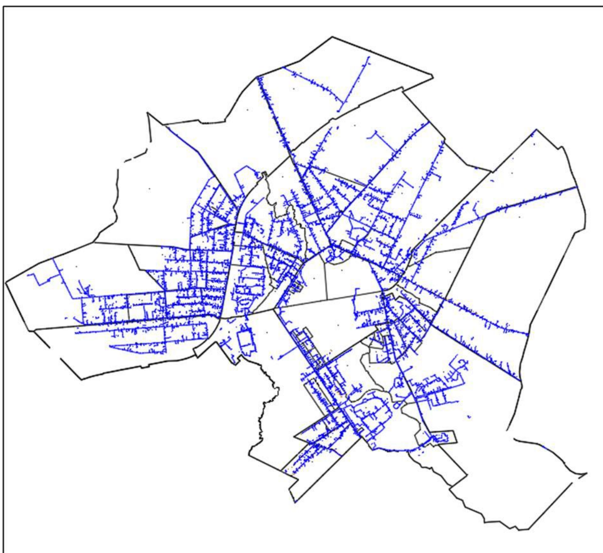
Rysunek 4 Mapa poglądowa istniejącej sieci wodociągowej na terenie miasta Głowno (dane wektorowe) [sieć wodociągowa oznaczona została liniami niebieskimi]
