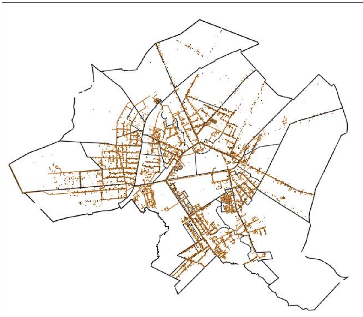
Rysunek 5 Mapa poglądowa istniejącej sieci kanalizacyjnej na terenie miasta Głowno (dane wektorowe) [sieć kanalizacyjna oznaczona została liniami brązowymi]
